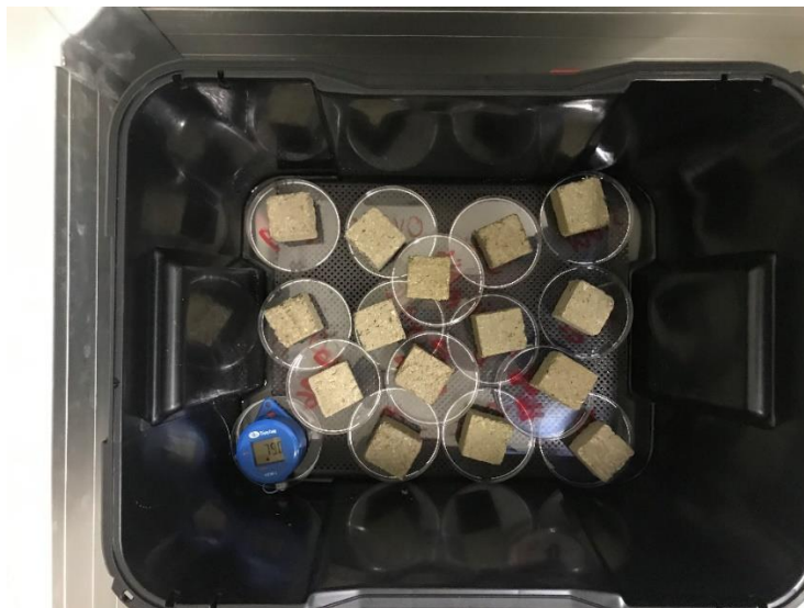
Figure 2.29 - Aperçu de la méthode dessiccateur.
