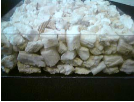
Figure 0.11 - Moelle de tournesol (Magniont, 2010).
