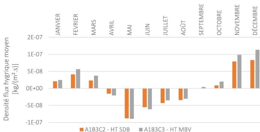
Figure 5.37 - Comparaison de la densité de flux hygrique MBV et salle de bains pour HB-S - Bourg Saint Maurice.
