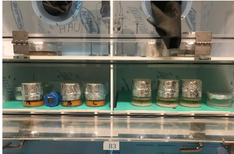
Figure 4.1 - Aperçu des coupelles sèches avec silica gel (gauche) et coupelles humides avec solution saline (droite).
