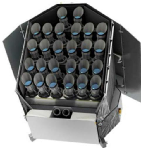
FIGURE 1.21: Illustration du futur observatoire PLATO avec ses 26 télescopes de 20 cm de diamètre chacun. Le satellite est prévu pour être lancé en 2026.
