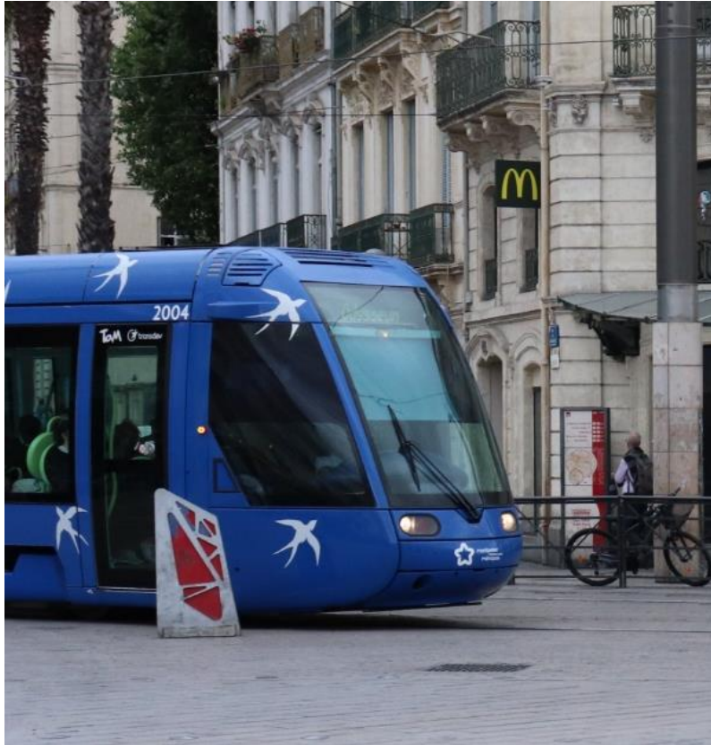
Figure 116 : Tramway de la ligne 1 positionné au point de limite de priorité (PLP)
