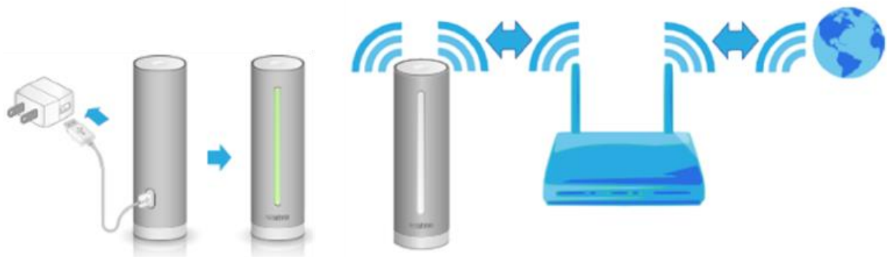
Figure 4.5- Schéma de Fonctionnement du capteur "Netatmo".
