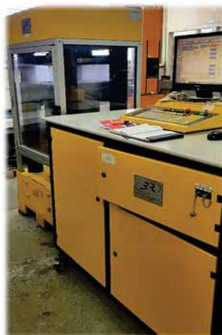
Fig. 8. Concrete press machine
