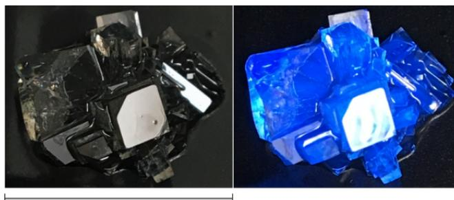
Figure II-19. Polycristal d'IRMOF-9 sous lumière visible (gauche) et sous lumière UV (droite). La barre représente 10 mm.
