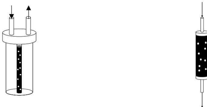
Figure IV-34. À gauche fiole de scintillation utilisée actuellement. À droite, cartouche permettant aux gaz de traverser l'échantillon.
