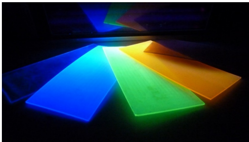
Figure I-10. Scintillateurs plastiques classiques du laboratoire sous excitation UV.
