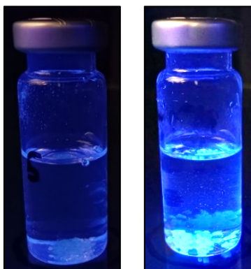
Figure II-51. MOF-5 (gauche) et MOF-5(ADC) (droite) sous excitation UV de 365 nm.
