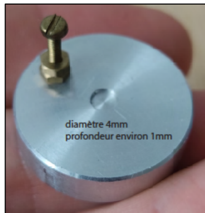
Figure II-4. Porte échantillon pour réaliser les mesures de RL et de TCSPC sous irradiation X (ILM).
