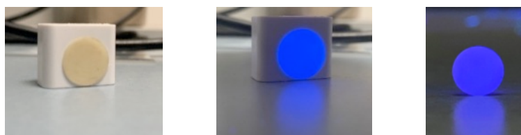
Figure III-9. Pastille sous lumière visible (gauche) sous excitation UV en réflexion (milieu) et sous excitation UV en transmission (droite).
