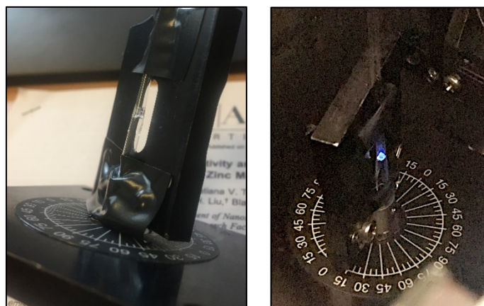
Figure II-3. Monocristal d'un MOF dans un capillaire en quartz fixé sur un porte échantillon (gauche) et à un angle de 15° par rapport à une source d'excitation (droite).
