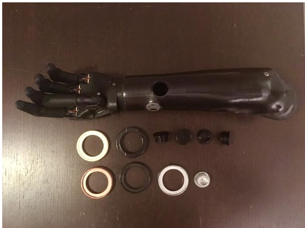
Figure 4 : Personnalisations et dispositifs d'ajustements esthétiques d'une prothèse de main.
