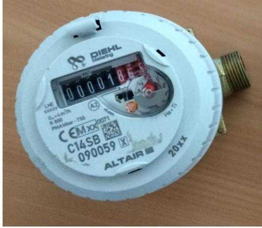
Figure 3.6: Compteur d'eau servant de totalisateur de la consommation d'eau avec un affichage d'un index mécanique
