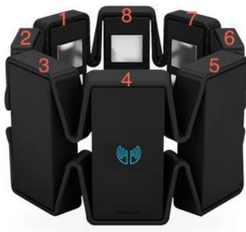
Figure 17 : schéma de placement des électrodes. Sources : image Thalmic Labs® et conception personnelle
