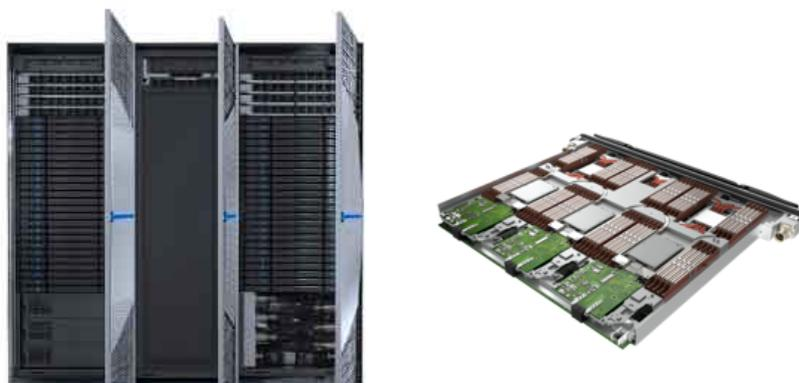
FIGURE 2.2 – À gauche, une armoire ou « rack », une brique de base pour un supercalculateur. Elle accueille notamment les lames ou « blades », qui accueillent les nœuds de calcul.
