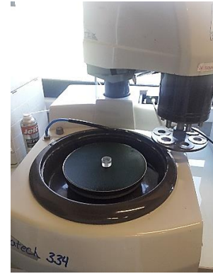
3. Polissage de l'échantillon sur papier SiC et disque diamant
