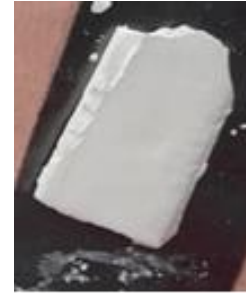
Figure III-24. Dépôt de silice obtenus à partir de suspension (70% eau – 30% éthanol) en fonction du taux de charge pondérale de la poudre (25%, 40% et 55%)
