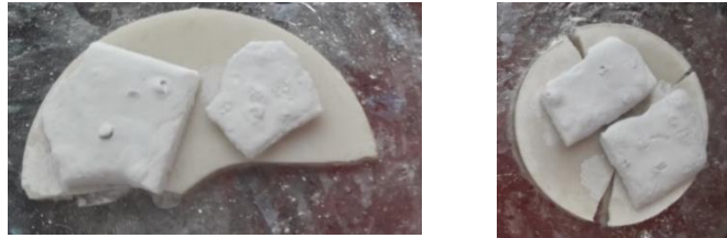
Figure III-31. Dépôt d'une suspension de \text{La}_2\text{SiO}_5 sur les substrats en \text{SiO}_2
