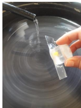
6. Polissage de la lame mince pour obtenir une épaisseur d'environ 40 \mu m
