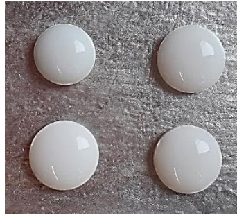
Figure III-20. Dépôt d'une suspension de \text{SiO}_2 sur les substrats en \text{La}_2\text{SiO}_5
