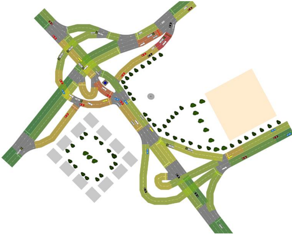
Figure 66: Aperçu de la distribution dynamique de densité de flux de l'étude de cas
