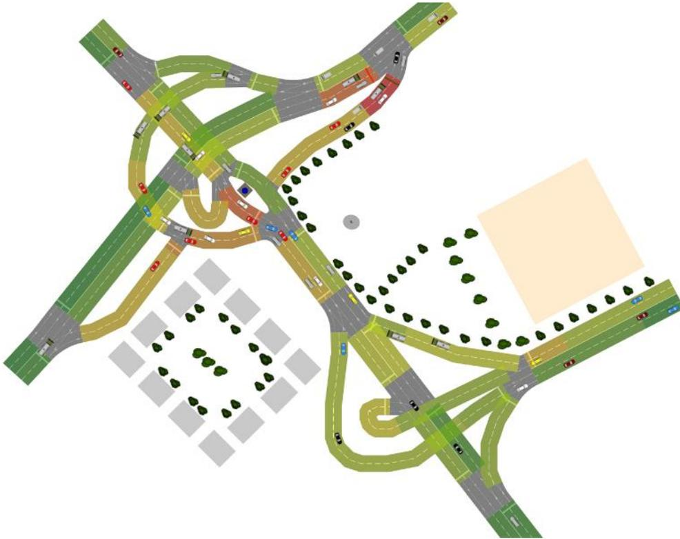
**Figure 66:** Aperçu de la distribution dynamique de densité de flux de l'étude de cas
