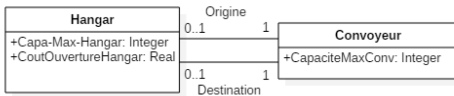
Figure 3. 18- Modélisation UML de l'association Hangar-Convoyeur
