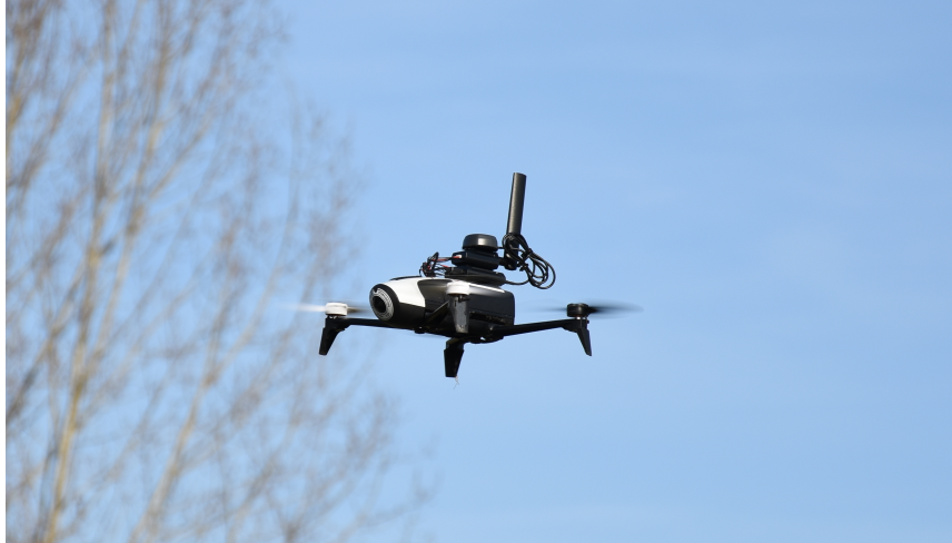
FIGURE 1.1 – Le drone Parrot utilisé, équipé du GPS RTK.
