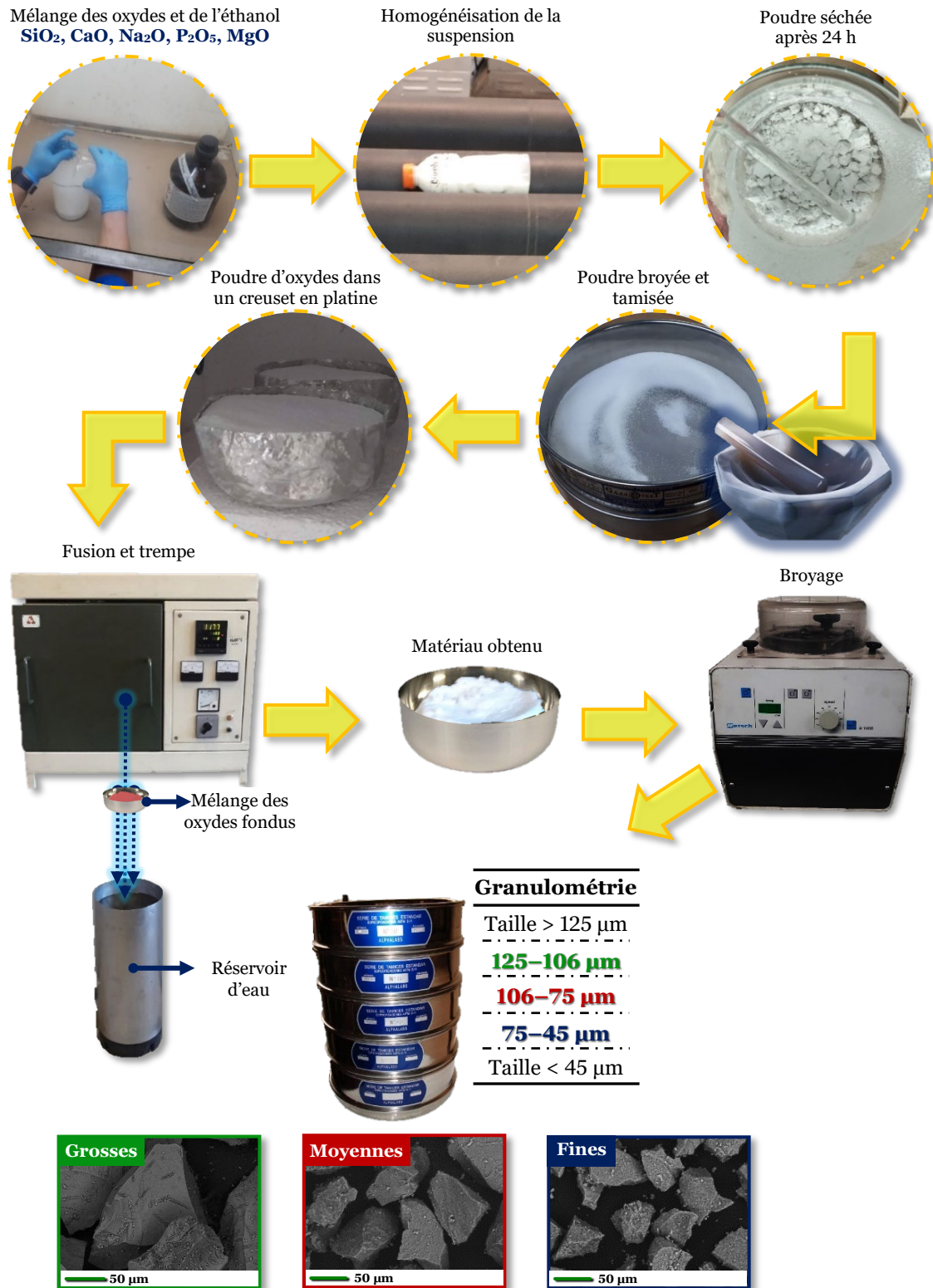
Figure II–4. Protocole de préparation des poudres
