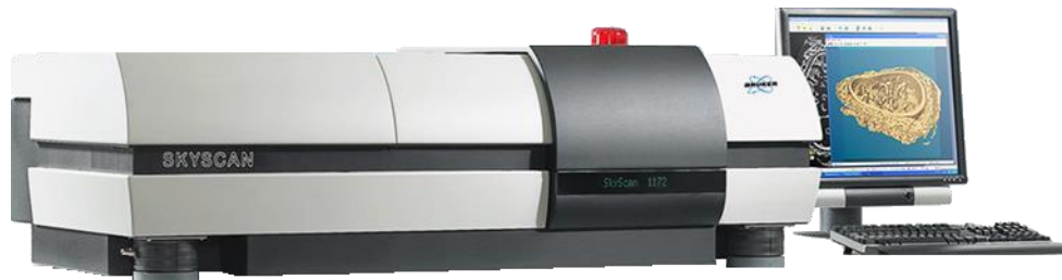
Figure 31 Microtomographie à rayons X Skyscan 1172 (Bruker mCT, Kontich, Belgique).
