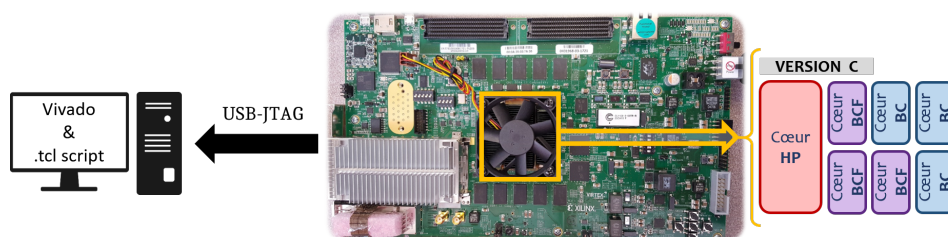
Figure 4.4 – Dispositif de mesure de la consommation de la carte VCU108.
