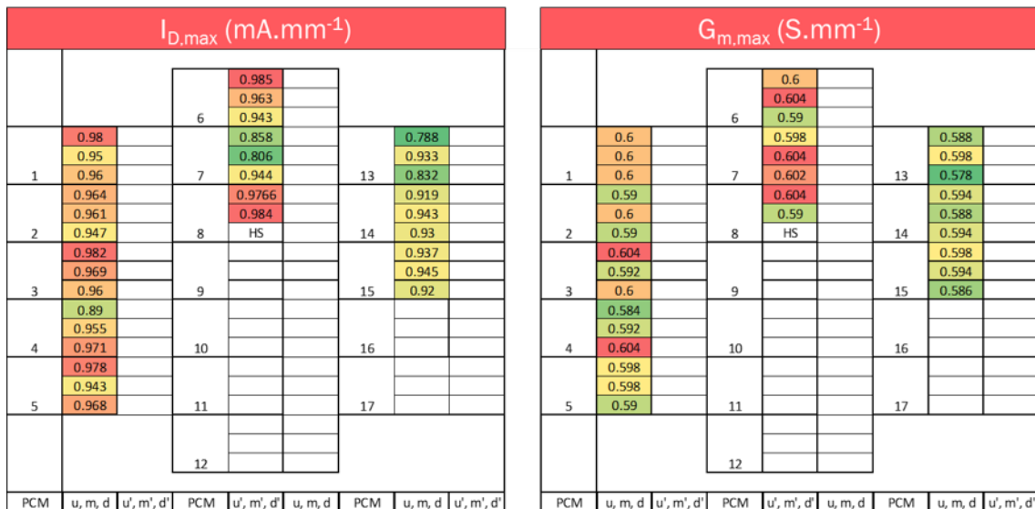
Figure IV.2 : Comparaison des performances de 32 HEMTs GaN normally-off de la plaque EVALGAN-2. I_{D,max} ( V_{GS} = 2 V) et G_{m,max} sont extraits à partir de la caractéristique de transfert mesurée à V_{DS} = 4 V. De vert à rouge, à mesure que les performances augmentent.
