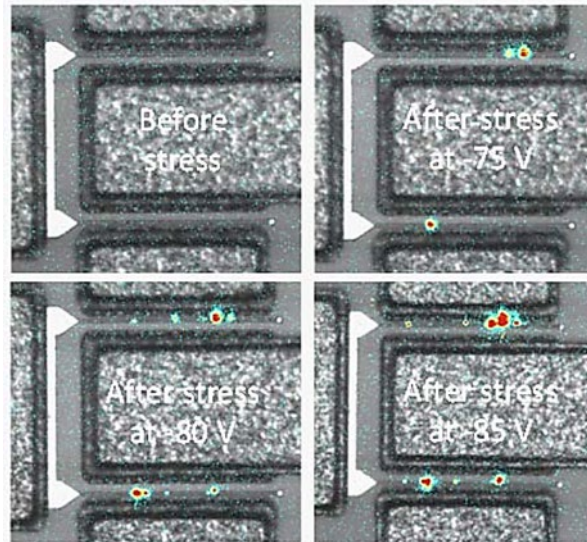
Figure IV.22 : Observation de spots lumineux par électroluminescence pour un HEMT AlGaIn/GaN soumis à une mesure de step-stress en champ vertical inverse ( V_{DS} = 0 V et V_{GS} négatifs). Les images sont capturées après chaque paliers de step-stress à V_{GS} = -10 V et V_{DS} = 0 V [138].
