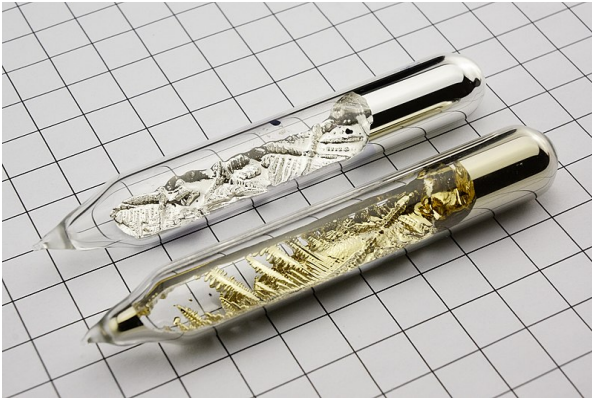
Figure 6.8 – Cristaux métalliques de rubidium (au-dessus) et de césium (en dessous) scellés dans des ampoules sous vide. Ces matériaux sont ignorés par notre méthode actuelle car leur indices valent respectivement \tilde{\eta}_{Cs} \in [0.53 + 0.32i, 0.28 + 1.7i] et \tilde{\eta}_{Rb} \in [0.19 + 0.37i, 0.11 + 1.98i] entre les longueurs d'onde 380nm et 780nm (mesures de Smith [Smi70]). Source : commons.wikimedia.org , propriété de ErpingWu.
