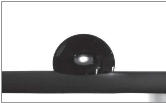
Figure 11. Exemple d'image prise lors de la mesure d'angle de contact sur un échantillon de fibre creuse en PTFE avant ozonation.
