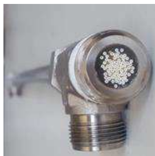
Figure 46. Photo du contacteur membranaire multifibre : répartition non égale des fibres
