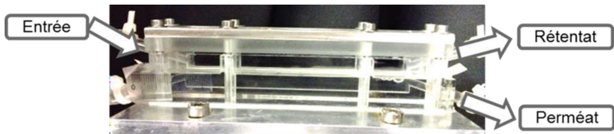
Figure 33 - Photo de la cellule de filtration pour l'expérience de Micro-PIV de Rey (2017)
