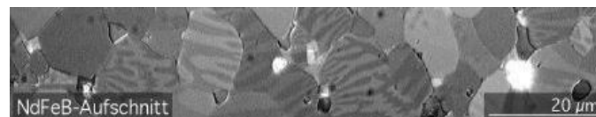
Figure 111.1 Observation d'un échantillon d'aimant néodyme au microscope par effet Kerr magnéto-optique [Gorchy].
