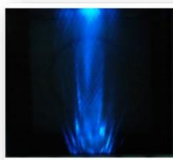
Figure 32 : Oxydation du luminol par les radicaux \text{HO}^\bullet (à gauche) et photographie de sonoluminescence d'une solution de luminol sous ultrasons (à droite, 422 kHz, irradiation par dessous) 264
