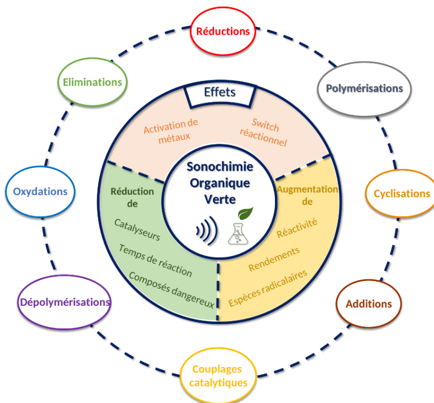
Figure 36 : Effets sonochimiques recherchés lors de l'étude de réactions organiques dans des conditions respectueuses de l'environnement et exemples de réactions étudiées 221,275,276
