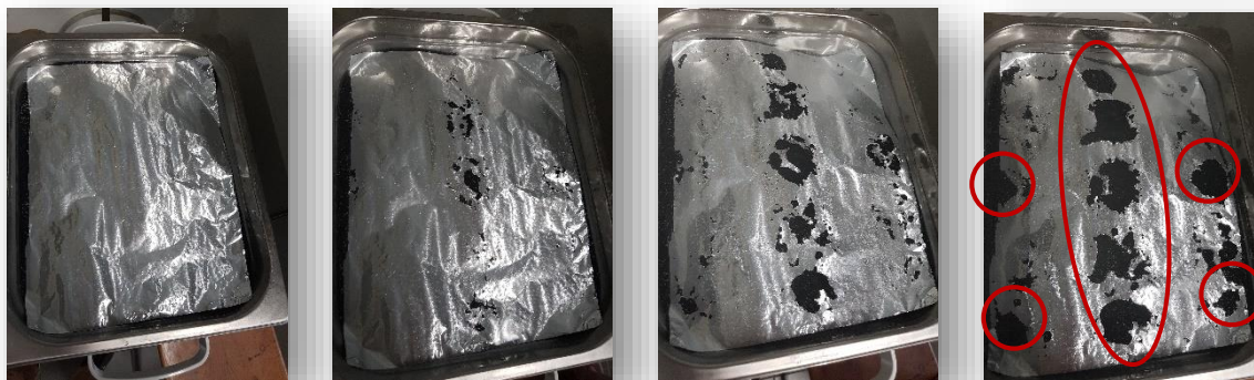
Figure A 1 : Perforation d'une feuille de papier aluminium après sonication au bac à ultrasons (Modèle : Advantage Lab AL 04-12, f = 38 kHz) à 0, 2, 4 et 6 min (de gauche à droite). Les cercles rouges représentent les zones les plus actives du bac utilisé.
