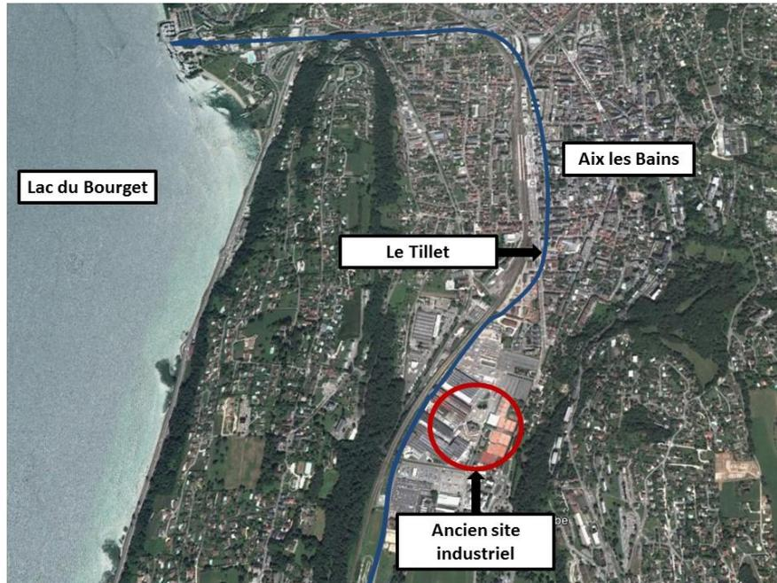
**Figure 13 : Carte de la localisation de l'ancienne industrie « Savoissienne de Constructions Electriques » ainsi que le tracé emprunté par la rivière du Tillet drainant les PCB jusqu'au lac du Bourget**
