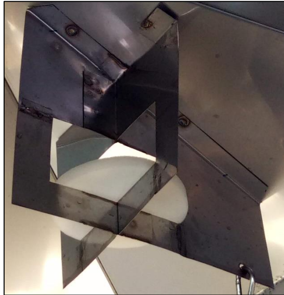
Photo 3: disque « PUF » sur son support dans l'enceinte de la chambre.
