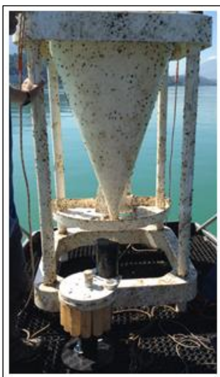
Photo 2: Trappe à sédiment TECHNICAP® PPS6 permettant l'échantillonnage des MES sédimentant dans le lac.
