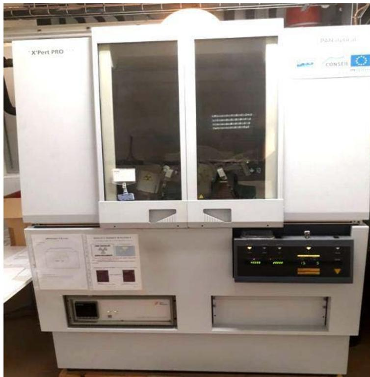
Figure B-2 : Diffractomètre X'pert Pro de PHILIPS.
