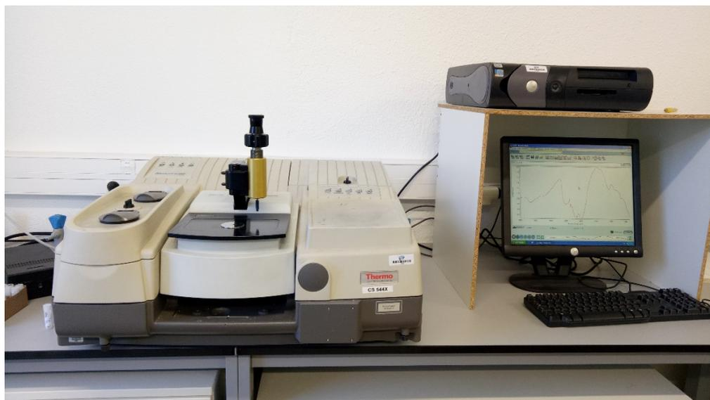
Figure B-4 : Spectromètre à transformée de Fourier NICOLET 5700
