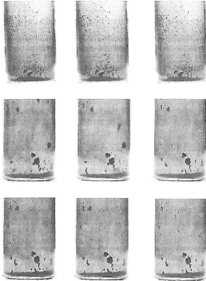
Figure 1.15 – Images obtenues à l'aide d'un microscope optique. Les trois premières images correspondent à des particules d'un dépôt formé après une exposition à un plasma de deutérium. Les six images suivantes sont des vues consécutives de particules issues de dépôts formés dans un plasma deutérium-tritium. Sur ces six images, on note une évolution dynamique, montrant la mise en suspension des particules tritiées en présence d'un champ électrique.
