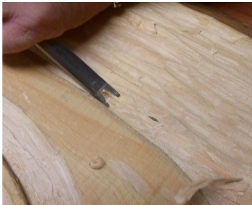
PHOTO 17 : CREUSER LES SILLONS DU BOIS AVEC LA GOUGE
