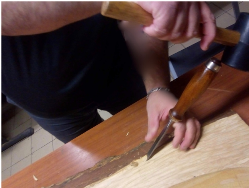
PHOTO 15 : EXTRACTION DE L'ECORCE DE BOIS AVEC LA BEDANE ET LE MAILLET
