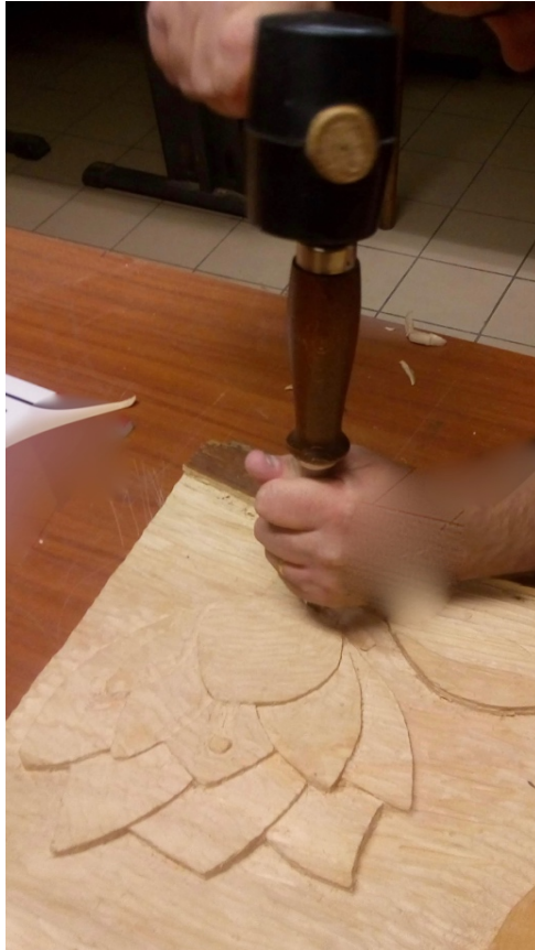
PHOTO 17 : CREUSER LES SILLONS DU BOIS AVEC LA GOUGE
