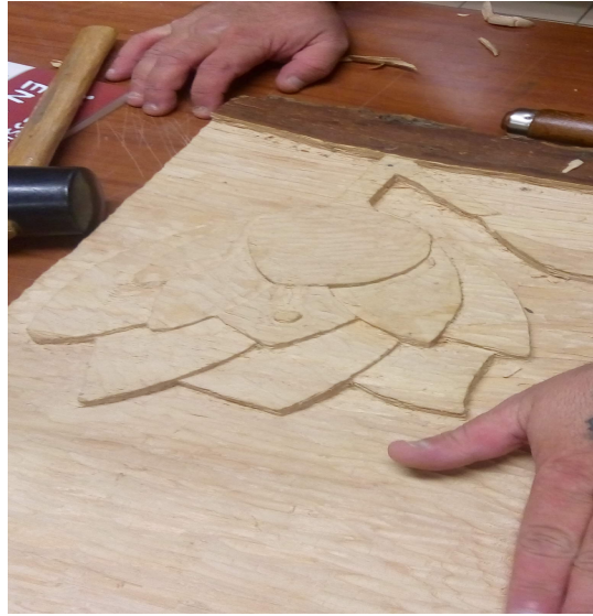
PHOTO 18 : CARESSER LE BOIS POUR RETIRER LES COPEAUX DE BOIS
