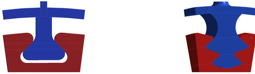
(a) Modélisation d'une attache type queue d'aronde. (b) Modélisation d'une attache type pied de sapin.
