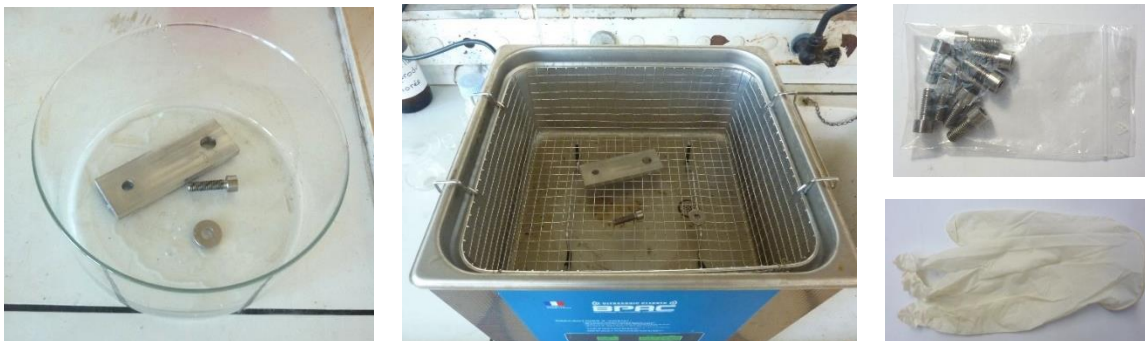
Figure A1-5 : Procédure d'obtention de conditions de contact sec.
