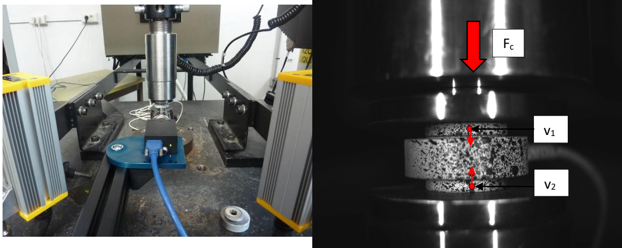
Figure A1-11 : Configuration des essais de mesure de la raideur équivalente du capteur d'effort.
