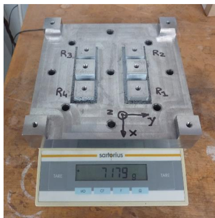
Figure A1-18 : Méthode de pesée des pièces pour recalage de la masse volumique.
