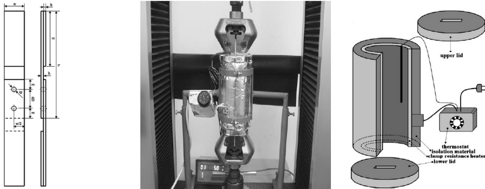
Figure 1-28 : Comportement de liaisons sollicitées en traction dans un environnement thermique uniforme. Spécimen (gauche) et banc d’essais (droite) [SOY, 2013].
