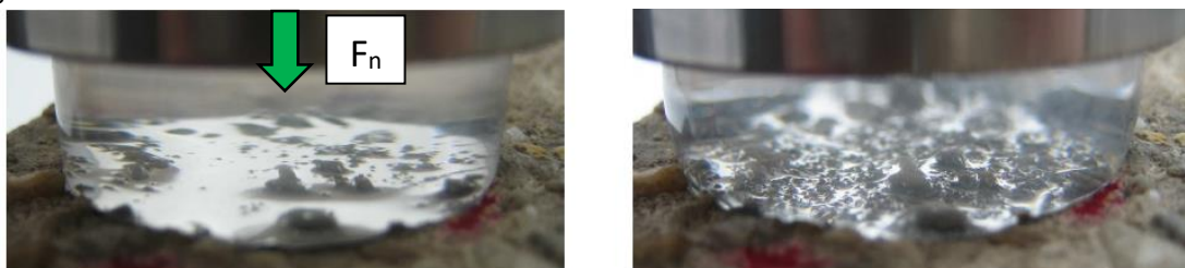
Figure 1-30 : Comportement normal de deux surfaces rugueuses comprimées l'une contre l'autre [LOR, 2012].
