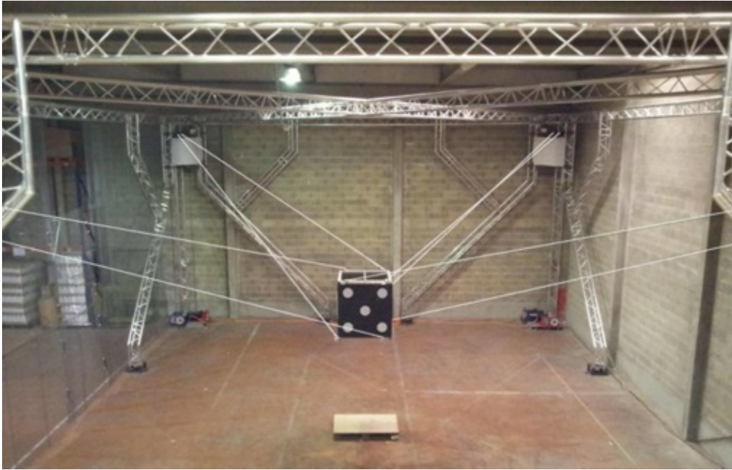
FIGURE 1.6 – Robot parallèle à câbles suspendu CoGiro [CoGiRo]
