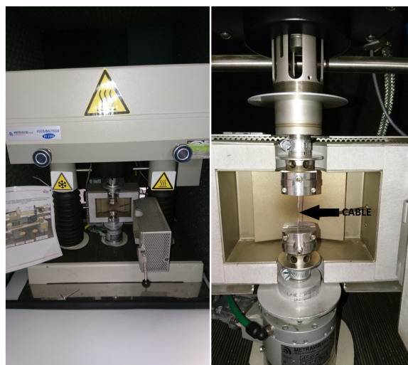
FIGURE 4.2 – Viscoanalyseur Metravib VA2000 pour analyse mécanique dynamique
