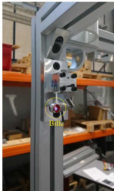
FIGURE 6.6 – Mesure de la position de la poulie
