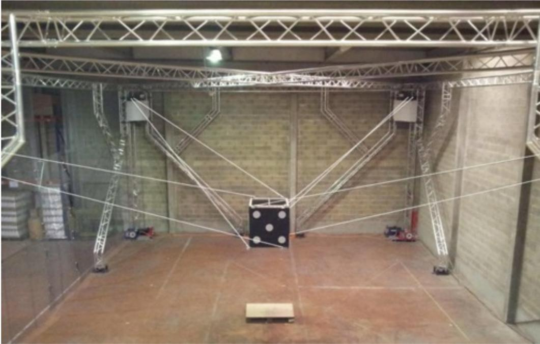
FIGURE 1.6 – Robot parallèle à câbles suspendu CoGiro [CoGiRo]
