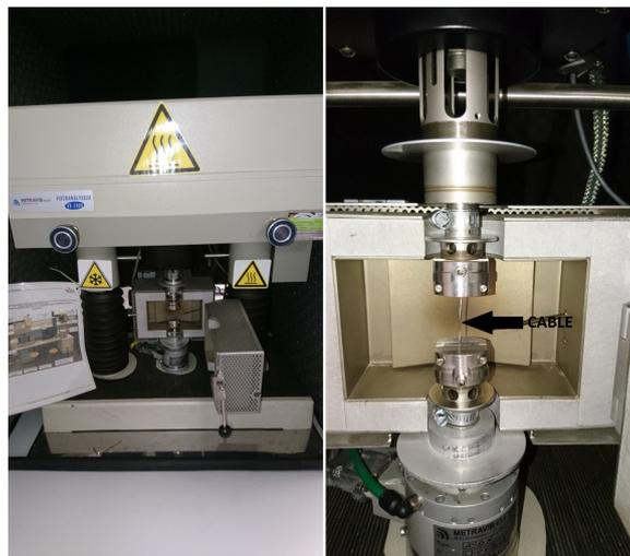
FIGURE 4.2 – Viscoanalyseur Metravib VA2000 pour analyse mécanique dynamique
