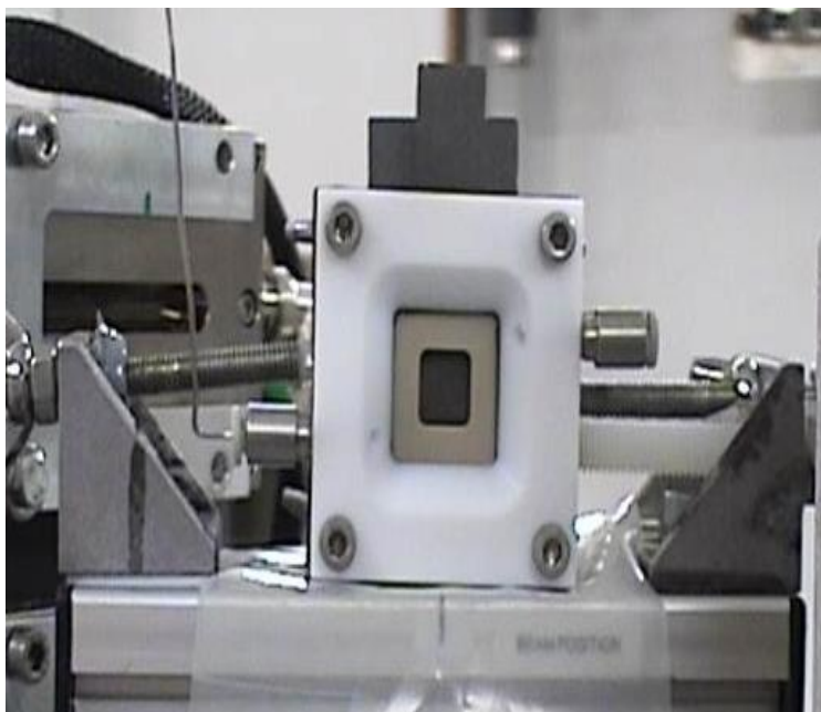
Figure 88 : Photo de la cellule utilisée pour les mesures operando XANES au cours de l'acquisition des courbes courant/tension des films \text{Co}_3\text{Mn}/\text{CP} en milieu \text{NaOH} 0,1 M.
