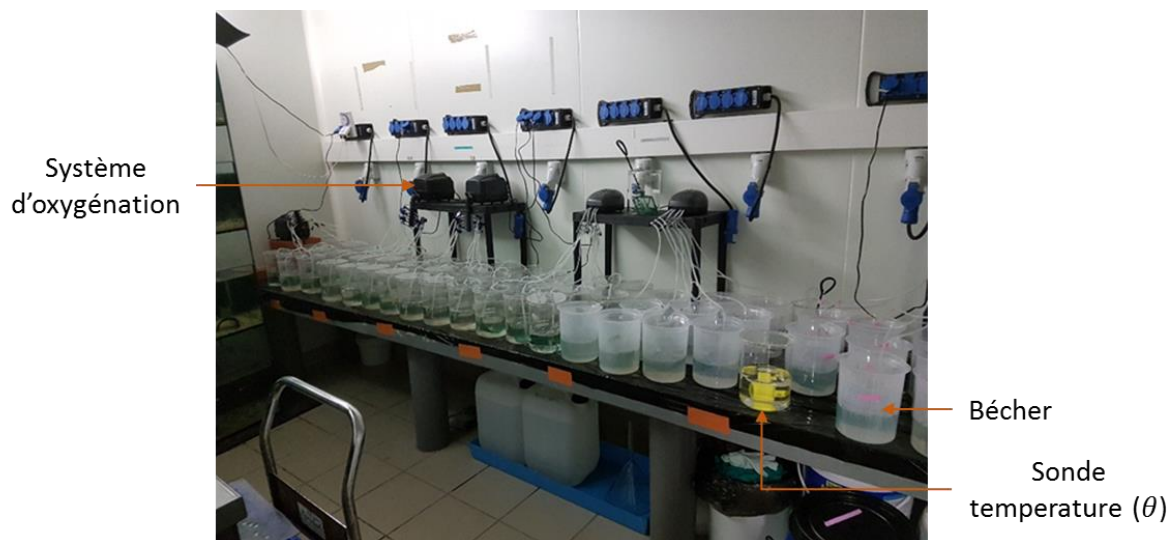
Figure III-3 Dispositifs mis en place lors des manipulations in vivo . L'oxygène est acheminé à chaque bécher par des bulleurs reliés à des pipettes Pasteur, afin d'obtenir un bullage fin. La température lors de l'exposition est vérifiée à l'aide d'une sonde température immergée dans 1 L d'eau de mer naturelle (crédit : M. Rollin)
