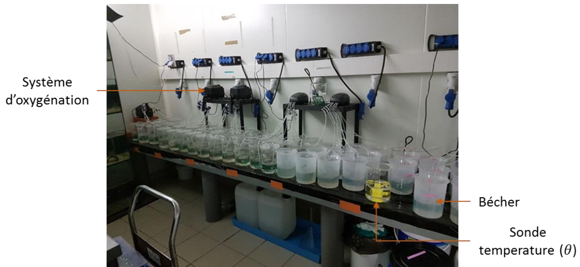
Figure III-3 Dispositifs mis en place lors des manipulations in vivo . L'oxygène est acheminé à chaque bécher par des bulleux reliés à des pipettes Pasteur, afin d'obtenir un bullage fin. La température lors de l'exposition est vérifiée à l'aide d'une sonde température immergée dans 1 L d'eau de mer naturelle (crédit : M. Rollin)
