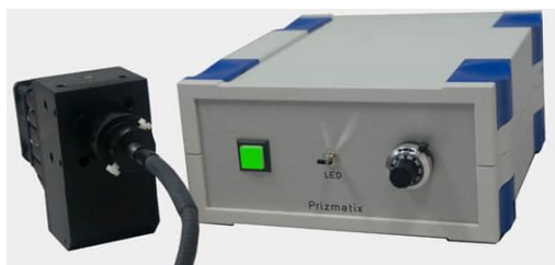
Figure III.3 : LED Prizmatix utilisé dans la manipe de thermoréfectance [Pri20]
