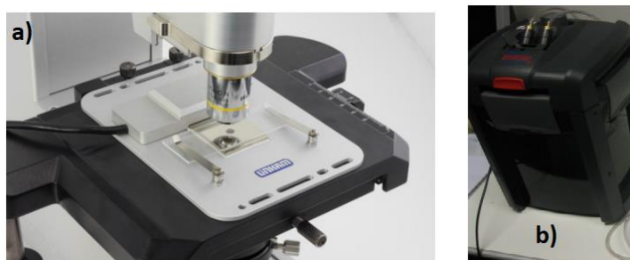
Figure III.9: Système Linkam PE120 : a) cellule de chauffage b) système de refroidissement [Lin20]
