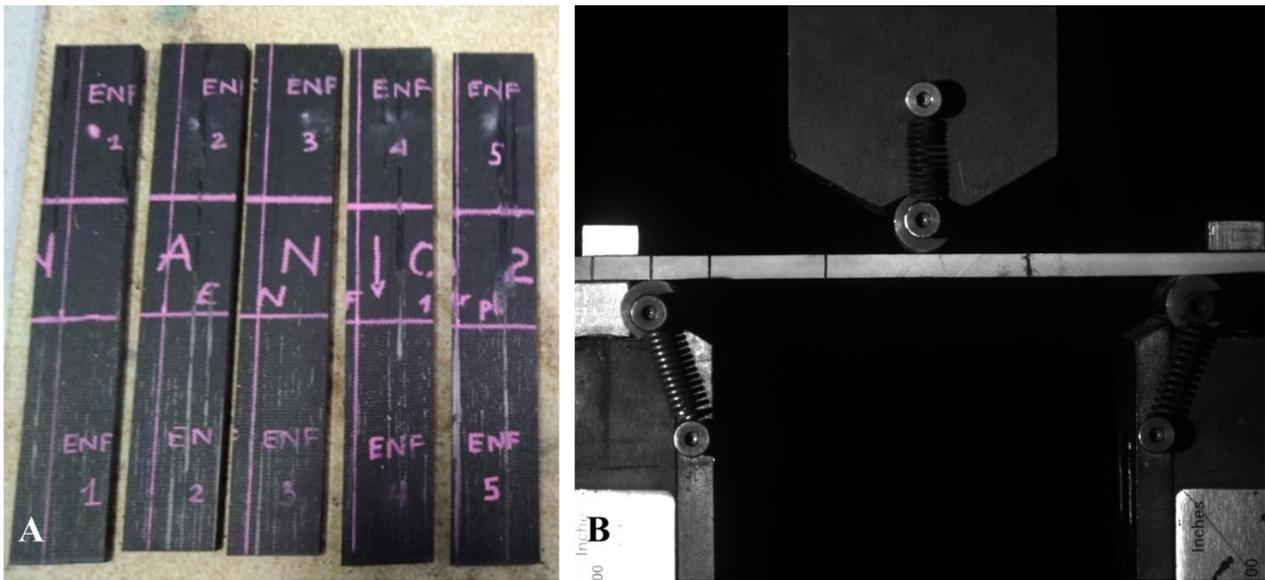
Figure 4.14 : (A) Les 5 échantillons ENF nano-renforcés découpés, (B) Un échantillon ENF mis en place pour l'essai ENF de fissuration par cisaillement.
