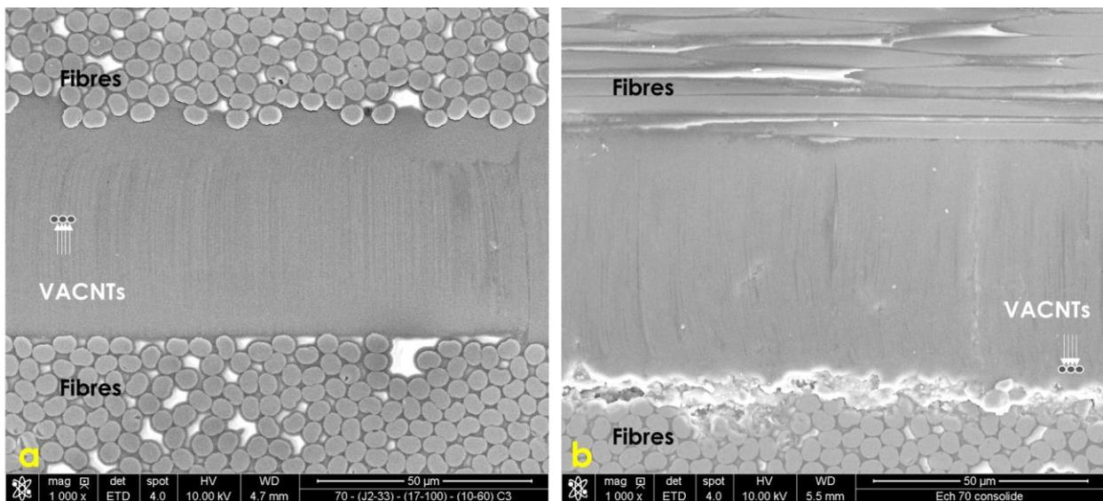
Figure 3.24 : Échantillon L consolidé - Conservation de VACNTs alignés verticalement après consolidation sur table chauffante avec maintien d'un vide de 1 bar en continu (images MEB).
