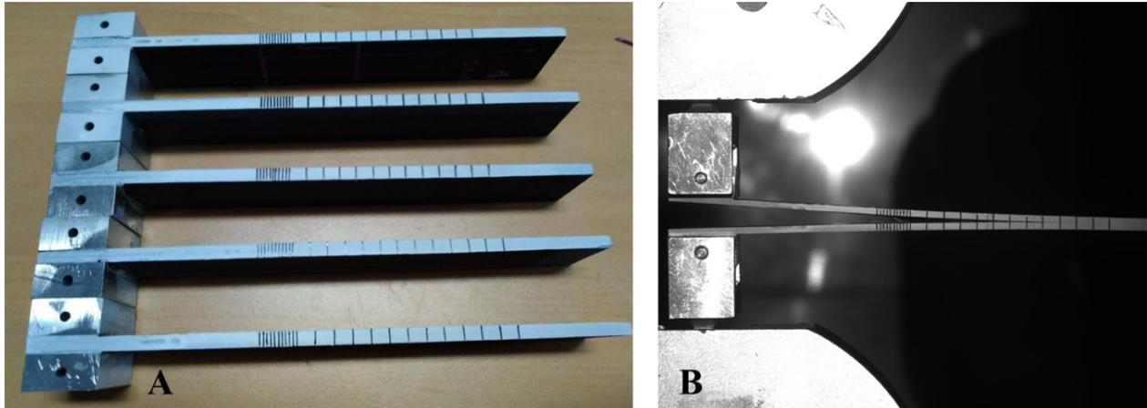
Figure 4.4 : (a) Les échantillons DCB prêts pour essais, (b) Un échantillon DCB en cours d'essai d'ouverture de fissure.
