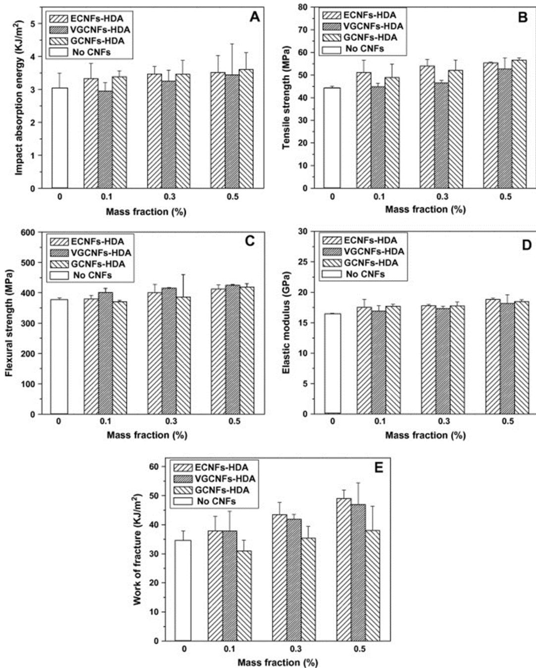
Figure 1.10 : (A) Énergie d'absorption d'impact de différentes recettes de composite nano-renforcé pour des teneurs de nanofibres variées ; (B) Résistance en traction ; (C) Résistance en flexion ; (D) Module d'élasticité ; (E) Énergie de rupture [42].
