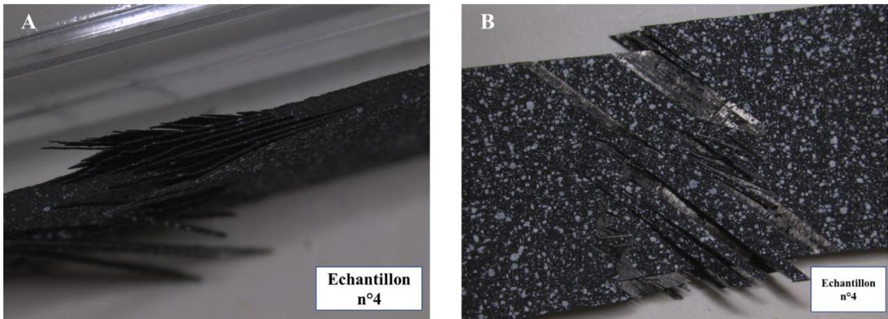
Figure 6.9 : Zone de rupture d’un échantillon composite nano-structuré  $(+45^\circ, -45^\circ)_{4s}$ . (A) Vue sur une tranche montrant que les plis extérieurs et intérieurs de l’échantillon sont endommagés, (B) Vue de face du mouchetis du même échantillon.
