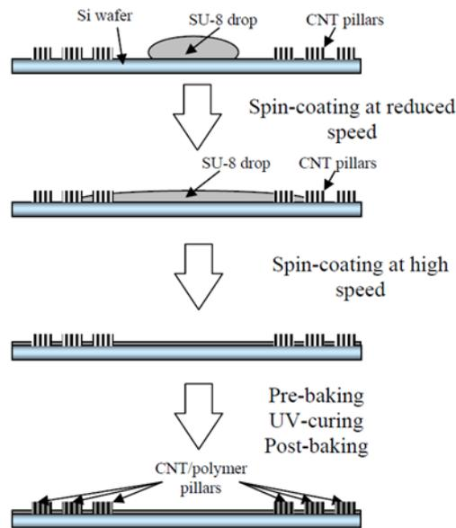
Figure 1.14 : Méthode 3 - Description de la méthode d'enduction centrifuge [49].
