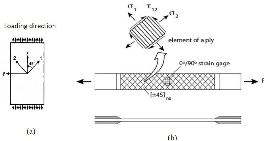
Figure 6.6 : (a) Repère global x-y (repère du chargement et de l’éprouvette) et repère local 1-2 (repère des plis constitutifs de l’échantillon) ; (b) Illustration d’un échantillon [92].
