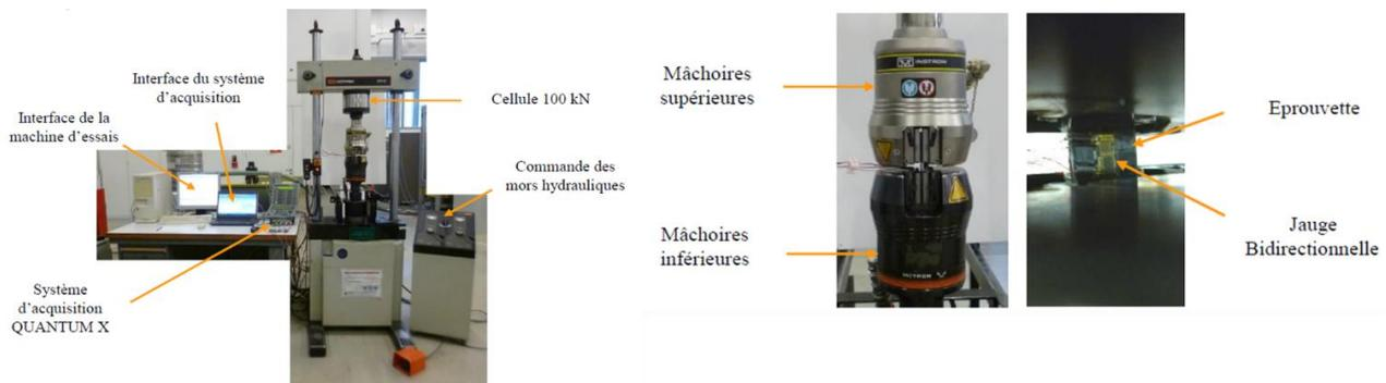
Figure 6.11 : Machine et configuration d'essais de compression sur composites (CRITT Mécanique et composites, Toulouse)
