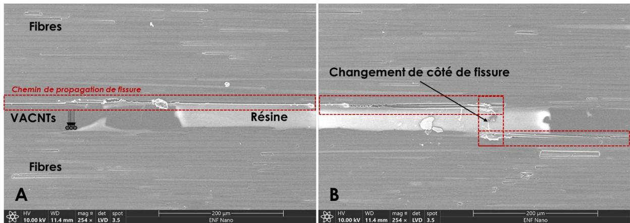
Figure 4.24 : Échantillon ENF nano-structuré – Vue d’une face latérale de l’éprouvette après propagation de fissure et au niveau de la zone nano-renforcée - Observations MEB du chemin de la propagation de fissure.
