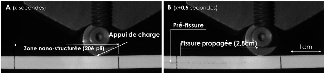
Figure 4.18 : État de propagation de fissure d'un échantillon ENF nano-structuré lors du premier chargement (C1). (A) Chargement en cours et fissure non amorcée ; (B) Fissure amorcée et propagée instantanément sur une longueur de 2,8cm (la fissure devient invisible après le déchargement).
