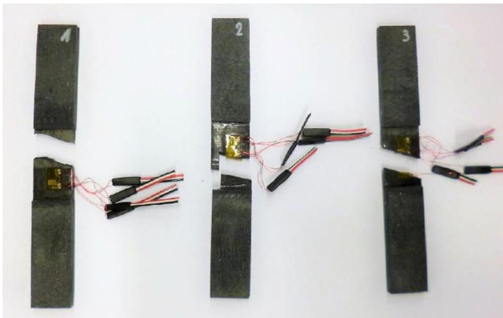
Figure 6.13 : 3 échantillons en composites nano-structurés (drapage  $(0^\circ)_{20}$  avec 19 plis le VACNTs) après les essais de compression : (1) et (3) rupture totale et conforme pour toute l'épaisseur des échantillons, les fissures d'endommagement ne dépassent pas la zone d'intérêt ; (2) la fissure s'est propagée de manière discontinue avec une zone de propagation qui se trouve très proche du talon inférieur.
