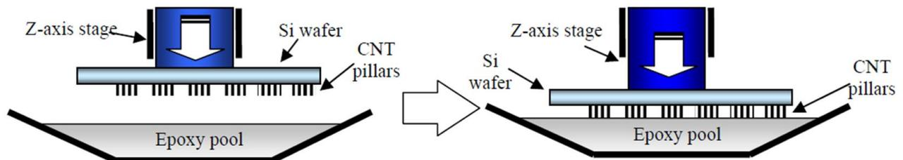
Figure 1.15 : Méthode 5 – Illustration du procédé d'immersion des nanotubes dans un bain rempli d'époxy [49].
