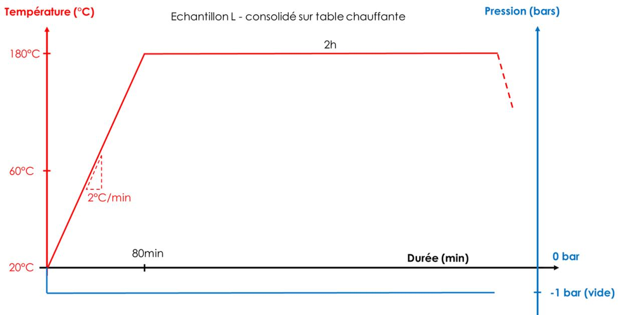
Figure 3.19 : Profils thermique et de pression pour la consolidation de l'échantillon L sur table chauffante.
