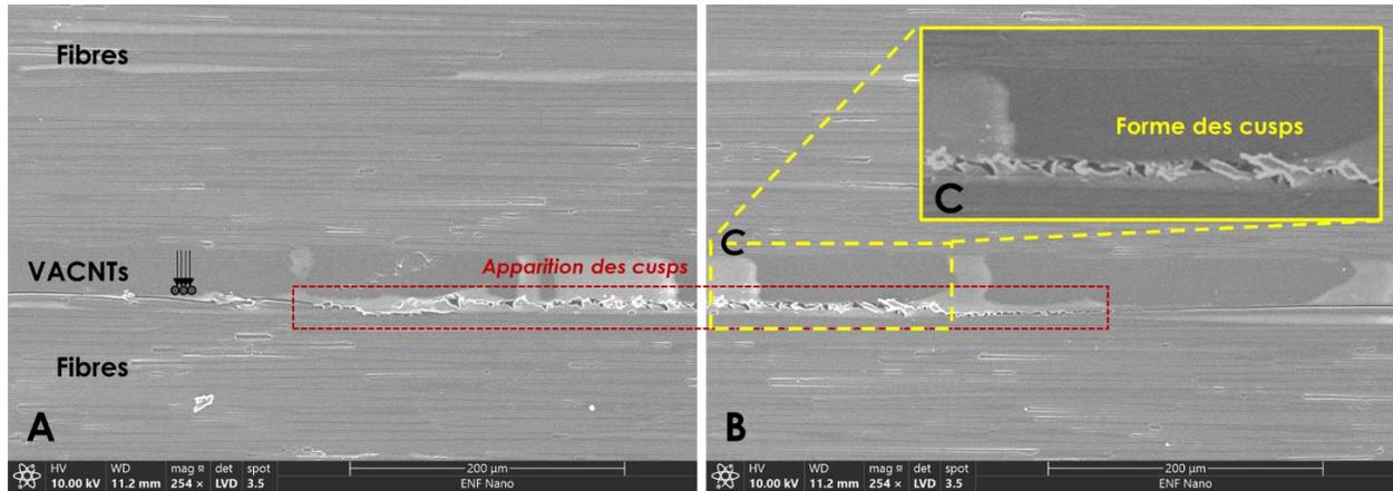
Figure 4.25 : Échantillon ENF nano-structuré – Vue d’une face latérale de l’éprouvette au niveau de la zone nano-renforcée - Observations MEB de la propagation de fissure. L’apparition de *cusps* est observée dans certaines zones de propagation de la fissure.
