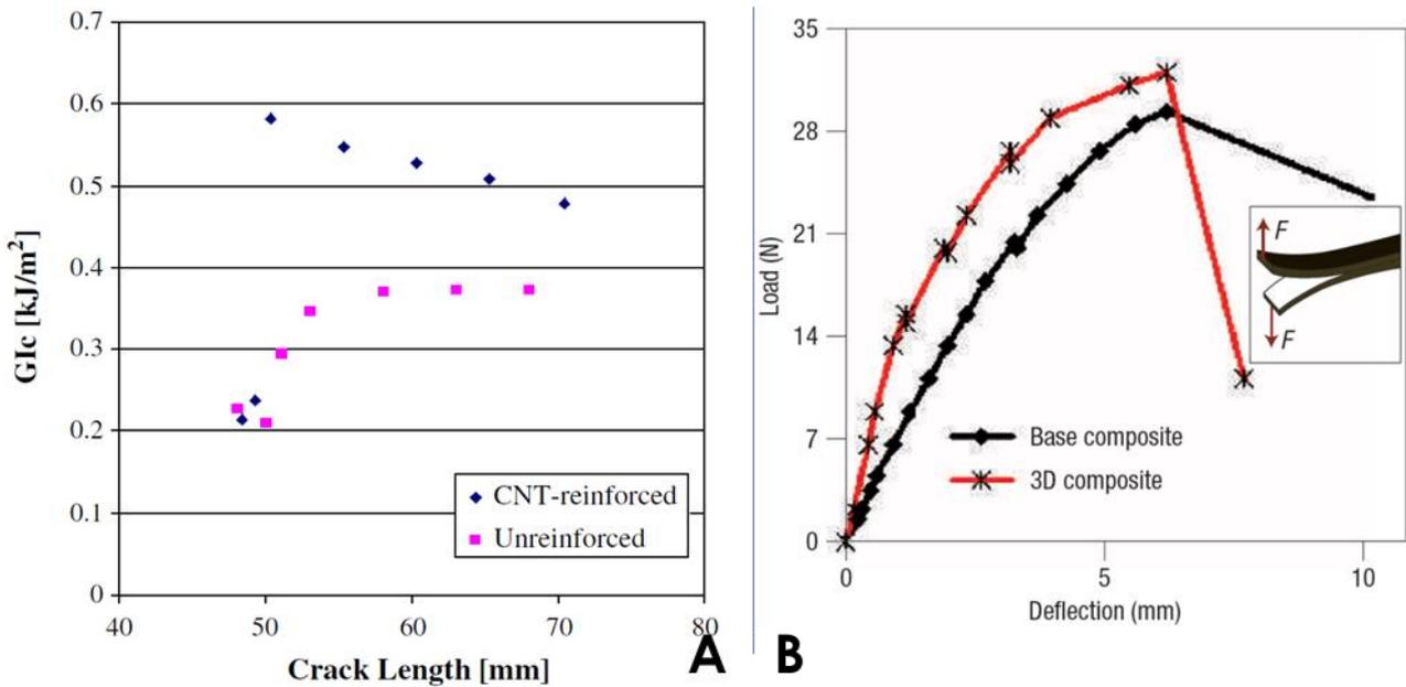
Figure 1.35 : Comparaison de la résistance interlaminaire en mode I des composites de référence et nano-structurés - (A) Courbe de ténacité en mode I [5] ; (B) Profils charge-flèche  $P - \delta$  dans le cas d'un échantillon DCB [6].
