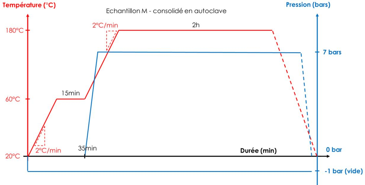
Figure 3.20 : Profils thermique et de pression pour la consolidation de l'échantillon M en autoclave.
