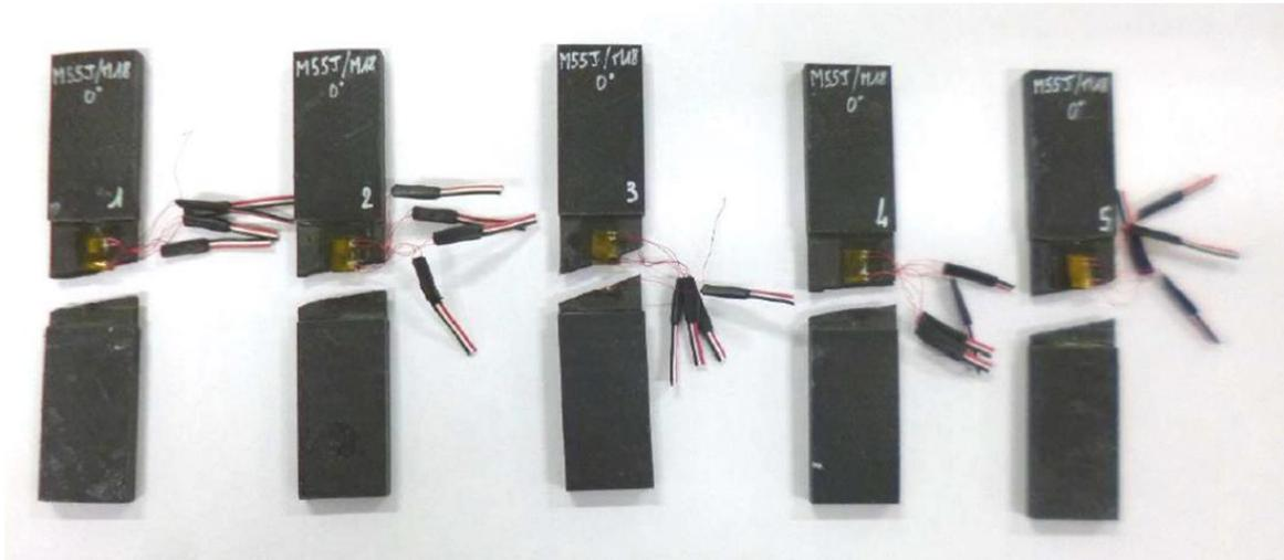
Figure 6.12 : 5 échantillons du composite de référence (drapage  $(0^\circ)_{20}$ ) ayant le même mode d'endommagement et de rupture en compression : rupture totale et conforme pour toute l'épaisseur des échantillons, les fissures ne dépassent pas la zone d'intérêt.
