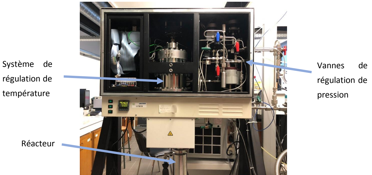
Figure 2.20 : Montage de l'analyse thermogravimétrique pour la mesure des isothermes d'adsorption
