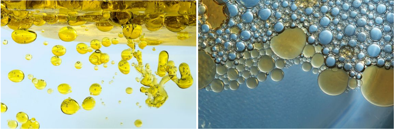
FIGURE 4 – Émulsions d’huile à différentes densités. ( gauche ) En-dessous de la densité de jamming. ( droite ) Au-dessus de la densité de jamming.
