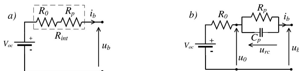
Fig. D.1. Schémas équivalents d'une batterie. a) Structure simple  $R_{int}$ . b) Thévenin.
