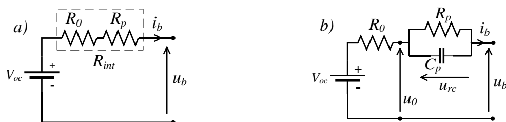
Fig. D.1. Schémas équivalents d'une batterie. a) Structure simple R_{int} . b) Thévenin.
