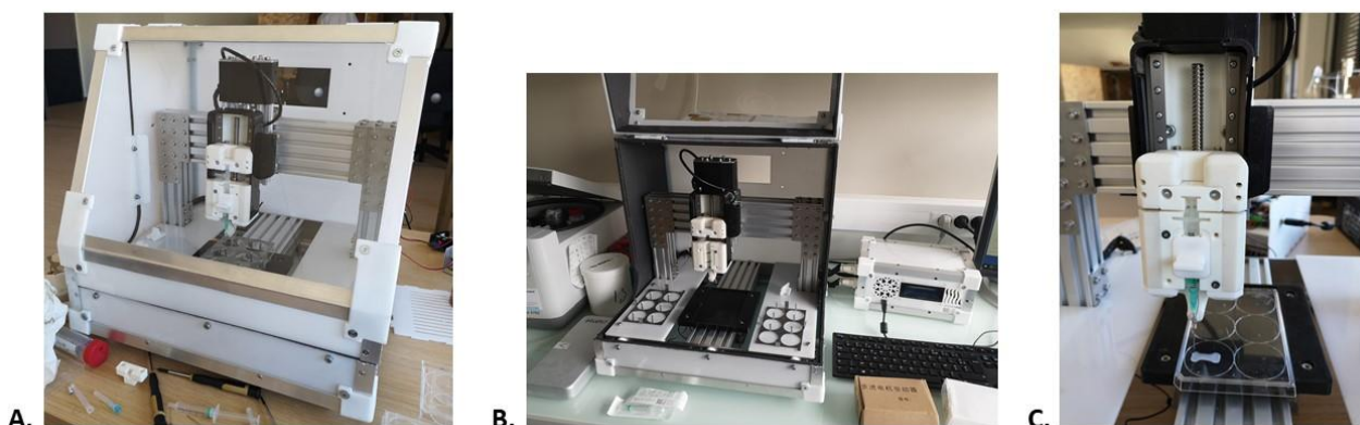
Figure 63: Seconde version de la bioimprimante à extrusion
