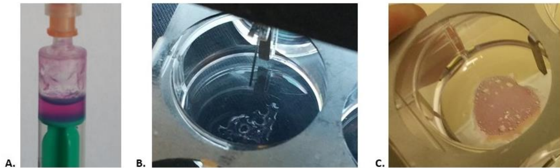
Figure 67: Test de formation en seringue et impression par imprimante du GNF 1% DMEM
