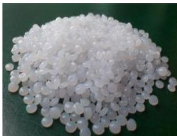
**Figure 32 : Granulés de polystyrène avant broyage, avec un diamètre d'environ 5 mm.**
