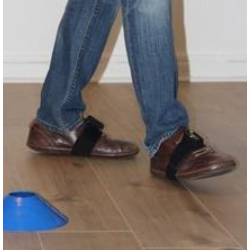
Figure 7. Positionnement des capteurs inertiels (Physilog® 5) disposés sur les pieds
